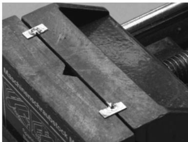
Mettre la pièce (1) dans un étau en laissant affleurer les encoches de marchepieds inférieurs. Glisser 2 marches (2) coté stries sur l'étau dans les encoches et souder.
