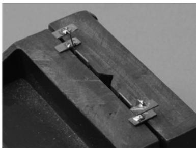
Remonter la pièce (1) dans l'étau en laissant affleurer les encoches de marchepieds supérieurs. Glisser 2 marches (2) coté stries sur l'étau dans les encoches et souder.
