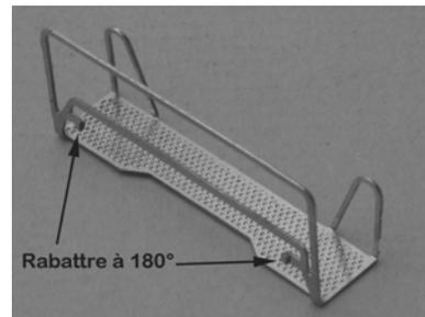
Mettre en forme la passerelle (3) en pliant les deux mains montoirs AR à 90° et la rambarde principale à 85° environ. Ensuite rabattre à 180° les 2 petits supports de lanterne et renforcer les pliages par de la soudure.
