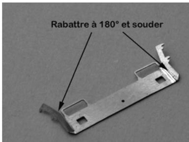
Mettre en forme la pièce (1) en commençant par plier les ailes latérales à 180°, renforcer immédiatement le pliage par une soudure.
