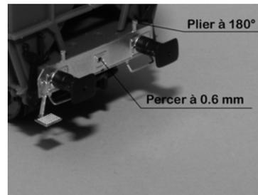
Monter la traverse sur le wagon. Percer 1 trou de 0.6 mm pour le crochet et souder en place le marchepied. On peut le souder avant montage sur la traverse.
