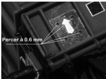
Positionner le gabarit de perçage suivant la position que vous voulez donner à votre cadre à étiquettes (haut / bas...) et percer 4 trous de 0.5/0.6 mm
