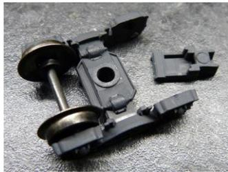
Supprimer sur le corps du bogie le support d'attelage d'origine.
