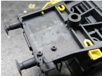
Démonter les deux bogies en tirant sur les pivots en plastique.
