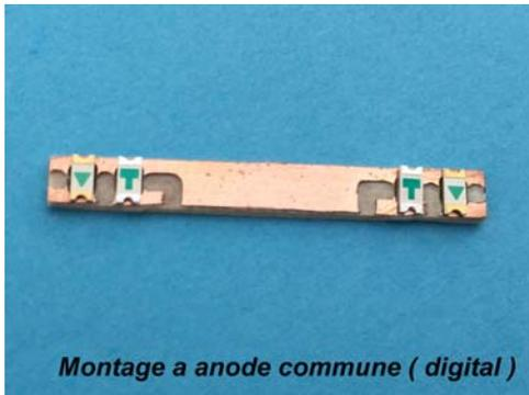
Les petits encastremets dans le circuit permettent aux diodes de rester en place pendant la soudure.
