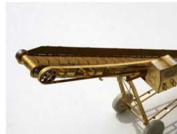
Mettre en forme la courroie (3) et ajuster ensuite la longueur, s'arranger pour faire la soudure vers le moteur...
