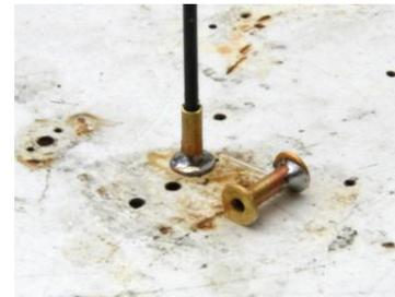
Réaliser 2 petits tambours en coupant 2 x 4/5 mm de tube et en soudant 2 rondelles (10) en vous guidant sur un foret de 1 mm.
