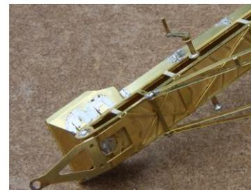
Mettre en forme la trémie (5), la centrer et souder sur les oreilles du châssis.
