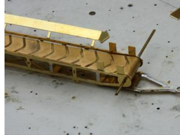
Glisser le tapis '1) pré-plié sur le tambour de tête, insérer un tambour au niveau du bas avec un axe de 1 mm.
