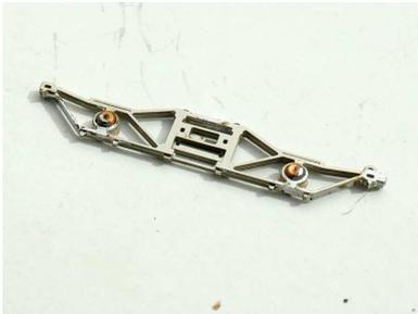
Dégrapper soigneusement les flancs de bogies (1 à 4). Poser à plat sur votre établi 2 paliers laiton, empiler dessus les 4 flancs dans l'ordre 1,2,3,4 attention cette pièce comporte une ½ gravure qui doit être visible (ajuster les trous de flanc si nécessaire) souder ces pièces par capillarité. Retirer soigneusement les excédents de soudure surtout au niveau des paliers.
