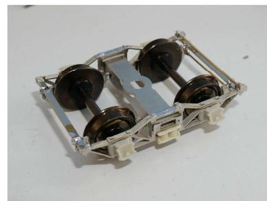
Dégrapper soigneusement les pièces en résine et les coller en place à l'aide de colle cyano. Chamfreiner les boites d'essieux pour montage
