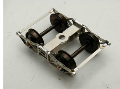
Mettre en place les essieux **coté isolé du même coté**, présenter le deuxième flanc de bogie et le souder en vérifiant sa perpendicularité.
