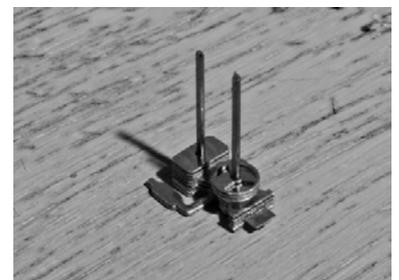
62. Mettre côté réservoir à carburant (le petit rectangle), 3 pièces (63). Souder l'ensemble par capillarité.
