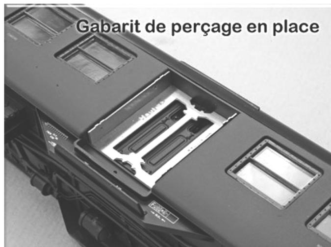
Dégrapper les pièces à l'aide pince coupante ou d'un petit burin. Former le gabarit en le pliant suivant les demi gravures, positionnez le en l'orientant flèches vers le toit, monter un foret de 0.5 mm dans une drille à main ou une mini perceuse et percer les 4 trous pour les rambardes latérales. Coller les rambardes latérales et ensuite la rambarde centrale.
