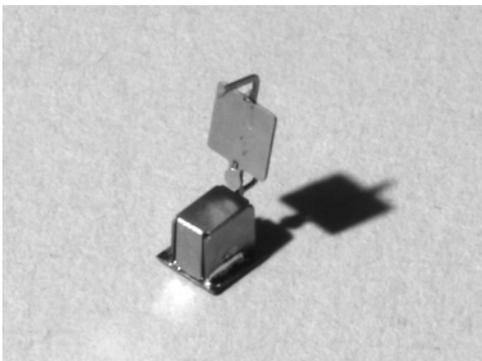
Plier maintenant complètement le coffre a piles, le mettre en place sur l'embase et souder.
