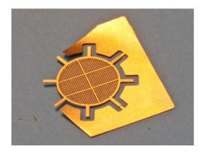
Ouvrir la machine suivant notice Mistral. Démonter la grille d'origine en soulevant délicatement les pattes de fixation (collées?) a l'aide d'un cutter ou Xacto.
