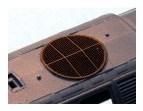
Monter la grille ainsi obtenue sur la toiture en vérifiant la bonne concordance des cotés pliés avec celle-ci.
