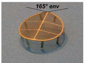
Plier la plaque suivant axe du renfort central à env : 165  $^{\circ}$
