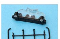
Démonter le locotracteur en dévissant la vis du dessous.
