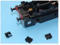
Démonter le châssis en déclipsant les extrémités et en appuyant sur les deux bossages qui dépassent dans le châssis, araser les 4 marchepieds d'origine, poncer proprement la surface d'appui.
