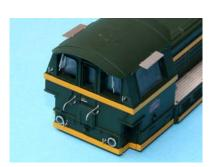
Percer suivant version 2 ou 4 trous de 0.5 mm pour les supports lanternes.
