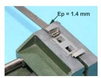
Mettre à plat dans un étau le marchepied (7) et positionner les marches (8); s'aider d'un objet de 1.4 mm d'épaisseur et souder par le dessous ou coller à l'araldite.
