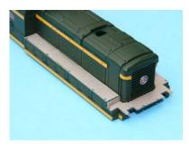
Coller en place les caillebottis (1) et (2) à l'aide de colle cyano en les mettant bien en butée dans l'angle de cabine.
