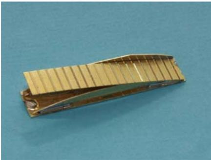
Présenter la rampe (4) et la souder a une extrémité en vérifiant son bon positionnement quand on lui fera suivre la courbe des supports...
