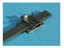
Caler le timon a environ 1.5 à 2 mm à l'aide d'on objet (ici une lime). Souder en ayant vérifié la cote de dépassement souhaitée.
